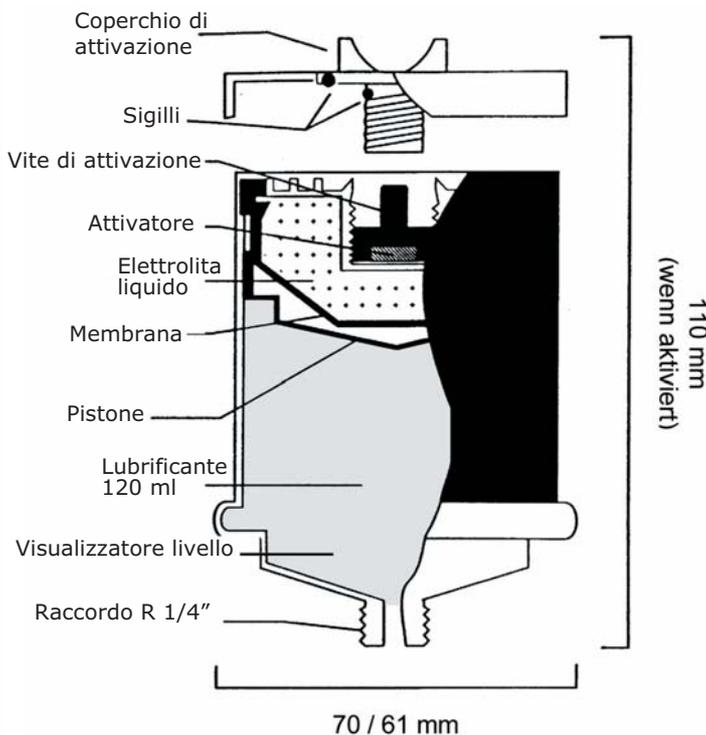
Il lubrificatore automatico è completamente automatizzato e molto robusto.
