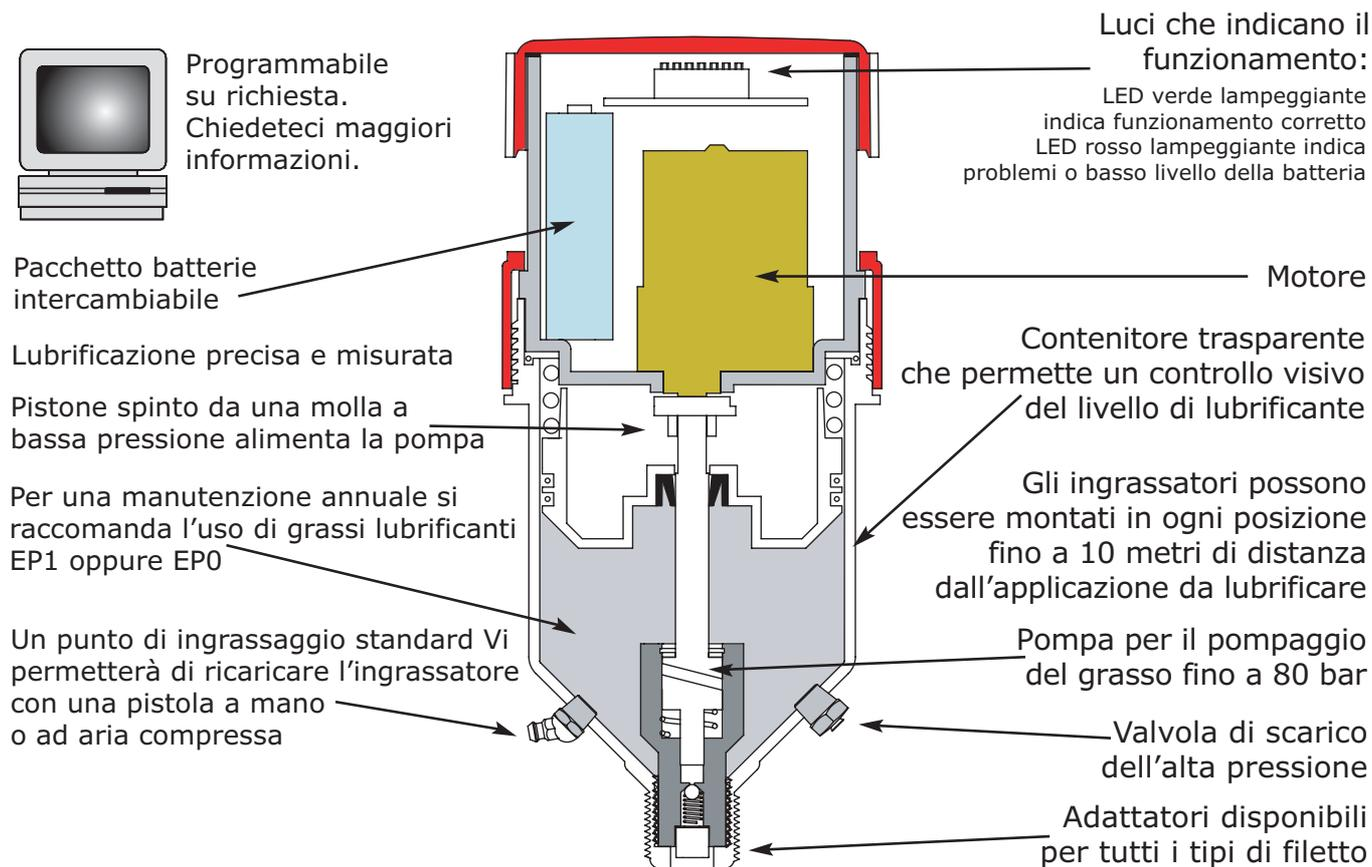
Temperatura di funzionamento -10°C to +76°C
