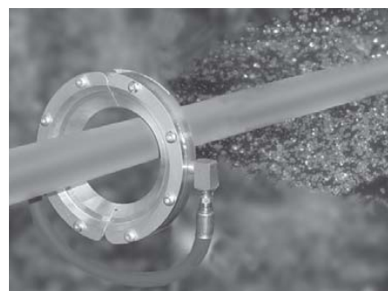
Air Gate Air tipo Air Wipe in asciugatura di un tubo di acciaio
